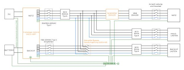
In diesem Fall empfiehlt sich ein 4-poliger Drehschalter wie im nachfolgenden Bild. Position 1 würde beispielsweise die Backup-Lasten mit dem Backup-Port des Wechselrichters verbunden halten, während Position 2 die Backup-Last mit der Hauslast verbinden würde. Der Vorteil dieses Schalters besteht darin, dass der Übergang durch die Stellung 0 (getrennt) einen sicheren Betrieb unter Spannung ermöglicht.
